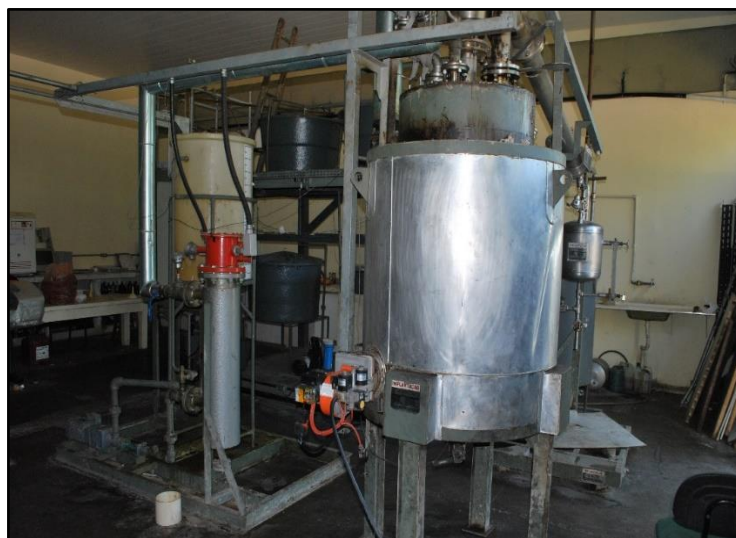
Figura 11: Unidade Piloto de Craqueamento/Pirólise.
