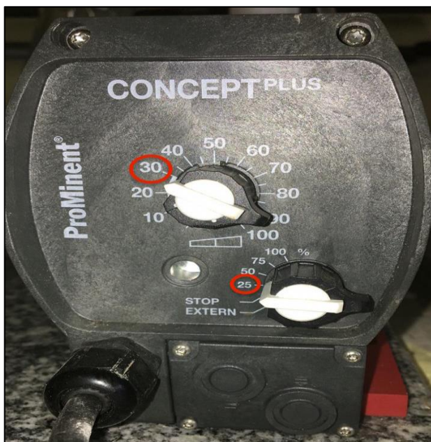
Figura 17: Programação da bomba dosadora nos ensaios de medição de vazão e ensaios de adsorção.
