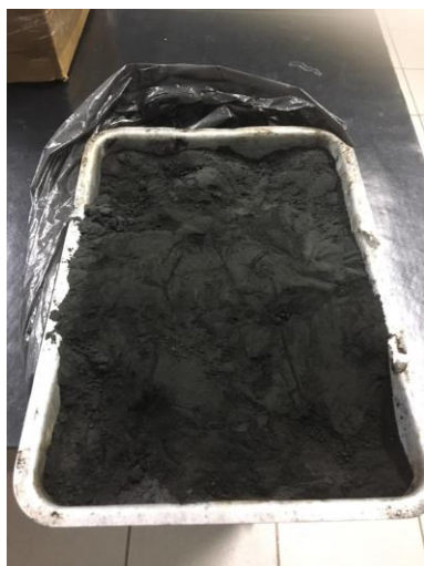
Figura 14: Carvão de açaí preparado após cominuição e peneiramento.
