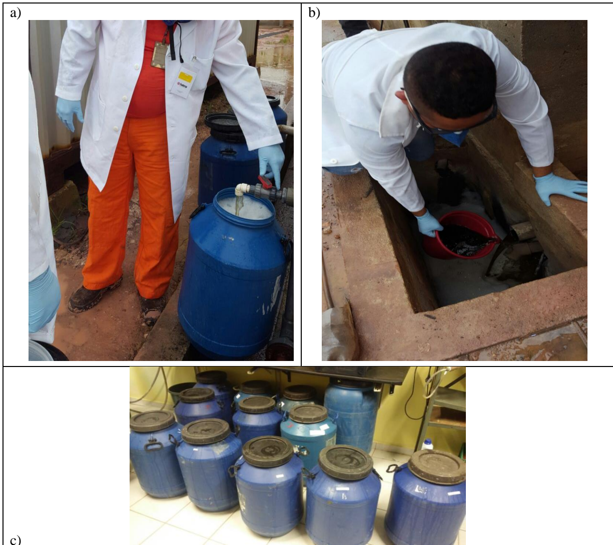
* Legenda: a) Coleta de lixiviado bruto por manobra de válvula na entrada da planta de osmose reversa; b) Coleta do lixiviado residual da osmose reversa; c) Disposição das bombonas no LAMAG.
